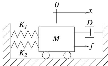
ただし、ばねの弾性係数を  $K_1$ 、 $K_2$ 、ダンパの粘性摩擦係数を  $D$ 、台車の質量を  $M$  とし、台車は摩擦なく床を動くものとする。また、 $f$  は図の方向に加わる外力とする。台車の平衡点からのずれを  $x$  とする。この振動系の運動方程式を求めよ。(2点)
