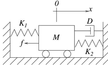
ただし、ばねの弾性係数を  $K_1, K_2$ 、ダンパの粘性摩擦係数を  $D$ 、台車の質量を  $M$  とし、台車は摩擦なく床を動くものとする。また、 $f$  は図の方向に加わる外力とする。台車の平衡点からずれを  $x$  とする。この振動系の運動方程式を求めよ。(2点)
