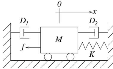
ただし、ばねの弾性係数を  $K$ 、ダンパの粘性摩擦係数を  $D_1, D_2$ 、台車の質量を  $M$  とし、台車は摩擦なく床を動くものとする。また、 $f$  は図の方向に加わる外力とする。台車の平衡点からずれを  $x$  とする。この振動系の運動方程式を求めよ。(2点)
