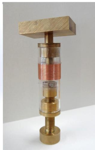
Fig.5 製作した共振周波数可変機構
